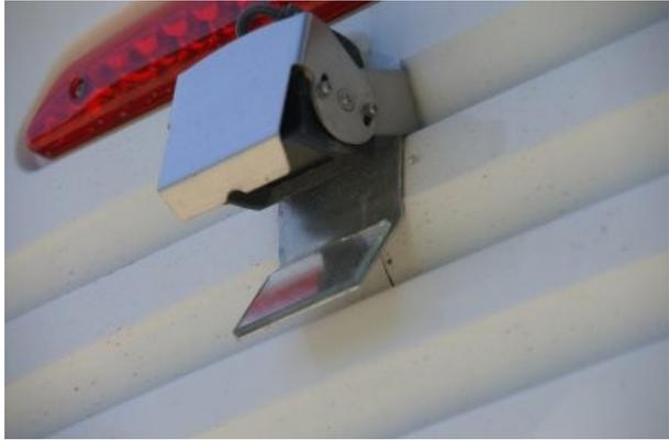
La plaque est montée sous la caméra avec du mastic silicone.
