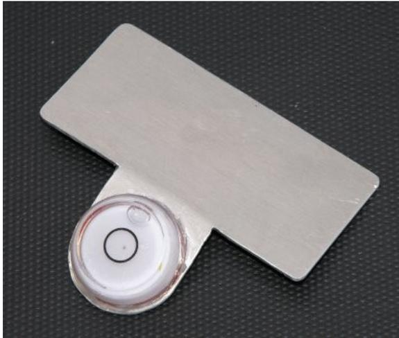
Le niveau est fixé sur le support avec du mastic silicone.
