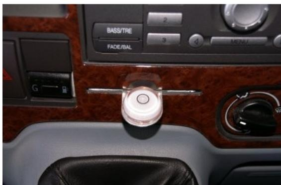
Le support du niveau est introduit dans la fente, et par essais successifs, on détermine le bon angle de pliage !!!
