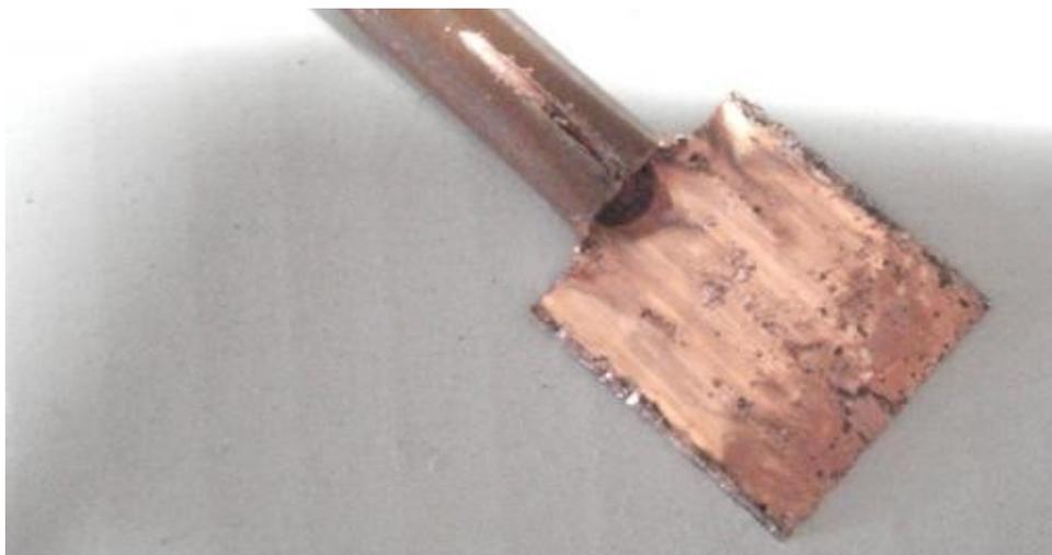
4 - Percer un trou du diamètre de la borne: Ø8,5
