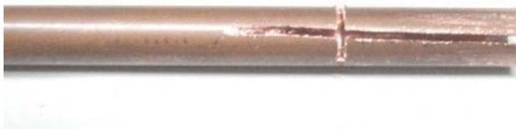
3 - Ecarter les bords à l'aide d'un tournevis, on écarte encore plus à l'aide d'une pince. Aplatir au marteau.
