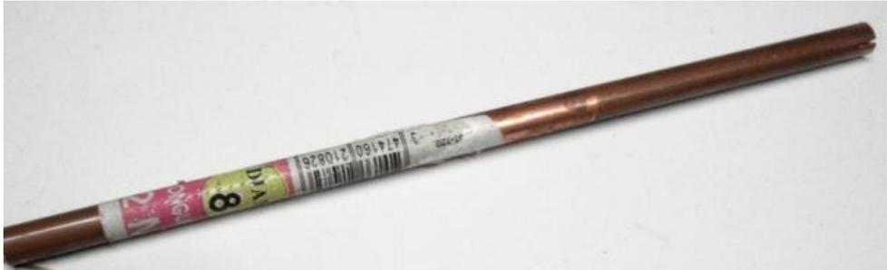
2 - A la scie à métaux, entailler dans le sens de longueur puis perpendiculairement sur un peu moins de la moitié du diamètre.
